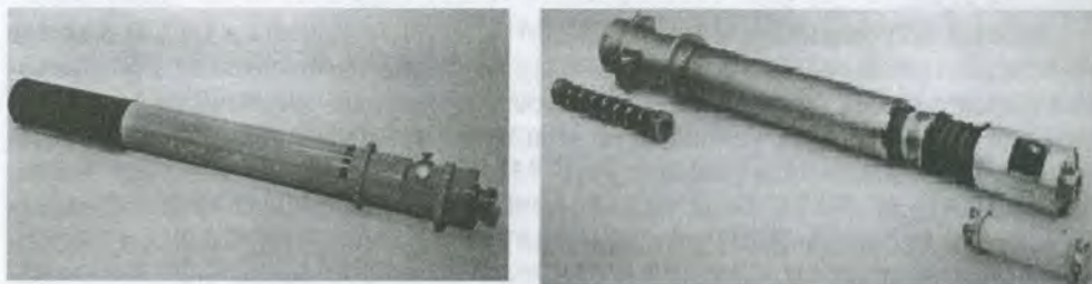
Рис. 3.2.3. Широкополосные гироклистроны «Стремя-1» и «Стремя-2»
