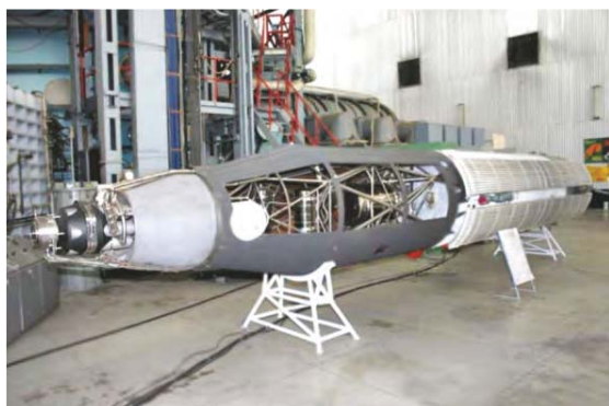
Спутник серии «Космос» с волноводно-щелевой решеткой РЛС бокового обзора «Чайка»
