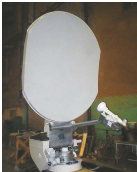
Складная офсетная зеркальная антенна с рефлектором диаметром 2,4 м для мобильных станций спутниковой связи
