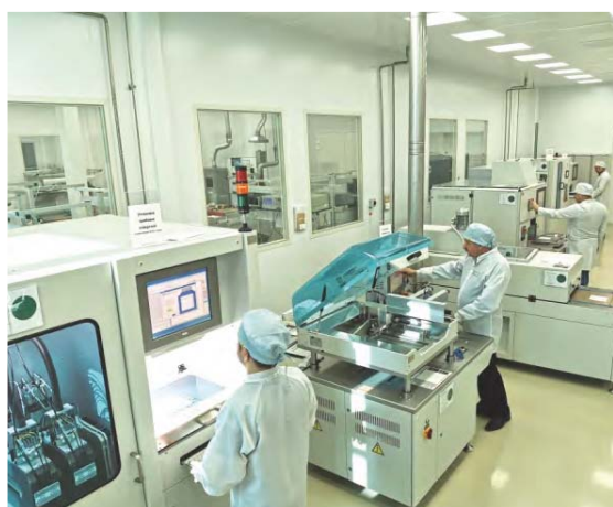
Участок изготовления керамических печатных плат по технологии LTCC
