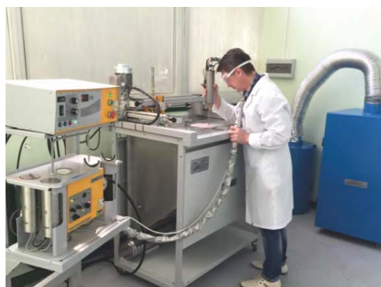
Участок специальных технологий: холодное газодинамическое нанесение покрытий
