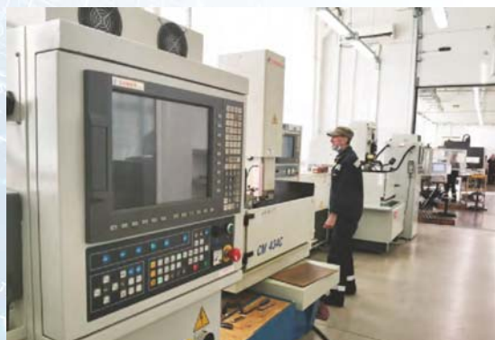
Участок ТМО: электроэрозионные станки с ЧПУ
