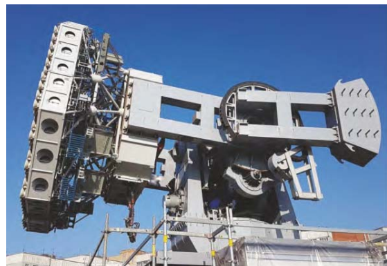
Монтаж РЛС Ка-диапазона на корабле «Маршал Крылов»
