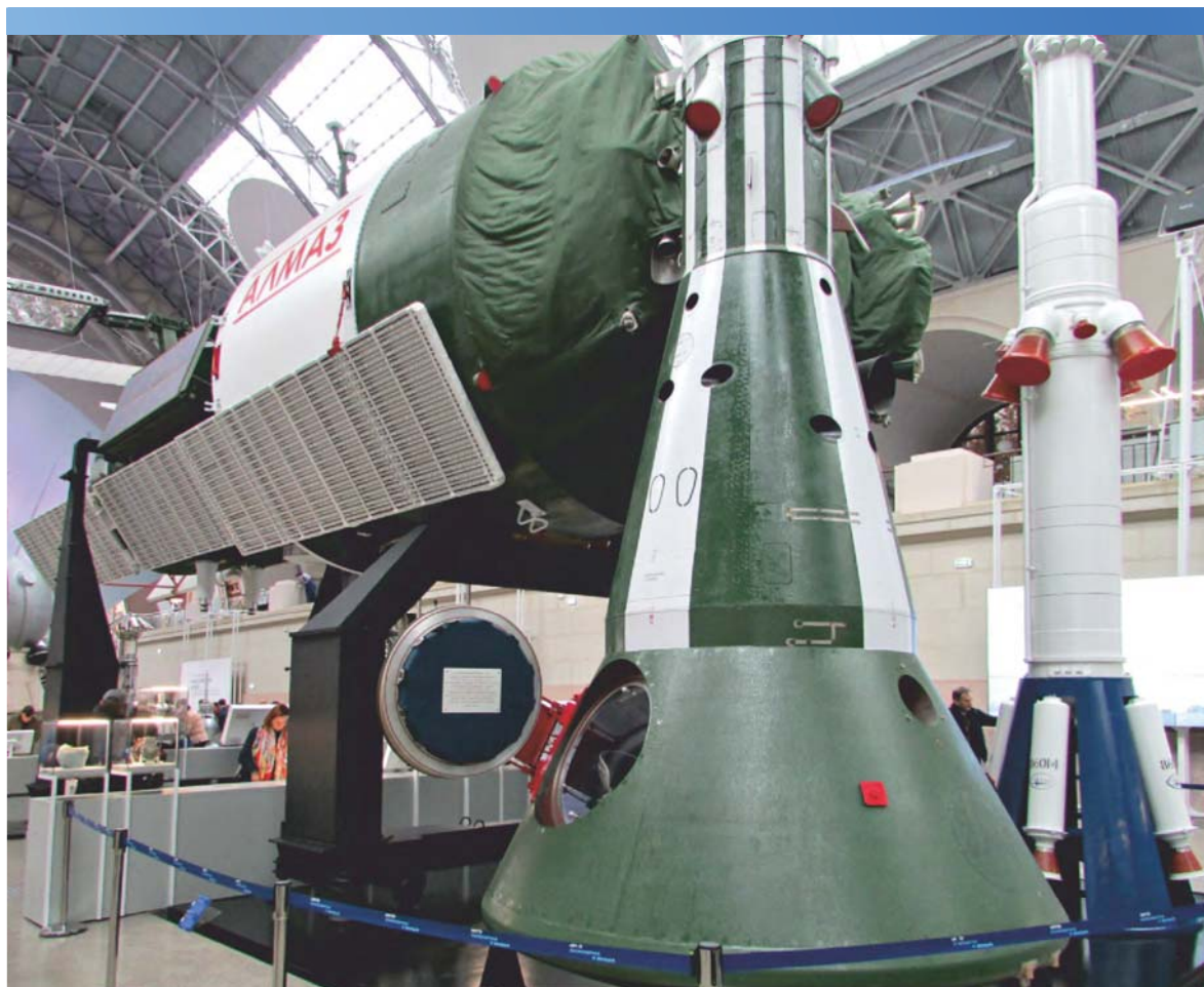
Станция «Алмаз» в павильоне ВДНХ. Волноводно-щелевые антенны радиолокатора обзора Земли «Меч», сконструированные в КБРП, установлены на боковой поверхности станции
