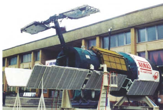
Станция «Алмаз». По бортам установлены две трехсекционные волноводно-щелевые антенны РЛС «Меч»
