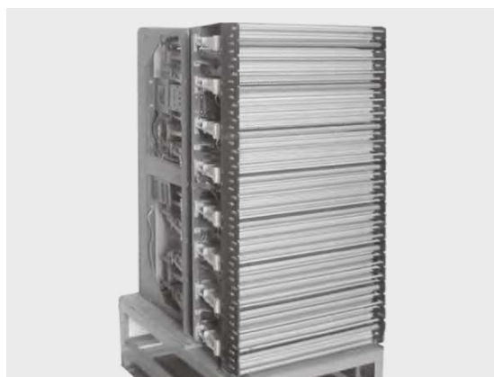
Передающая антенная секция ФАР комплекса 90М6 с излучающей структурой для сканирования в ограниченном секторе углов
