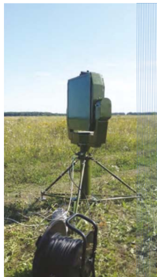
Наземный модуль РЛС системы посадки БПЛА на полигонных испытаниях
