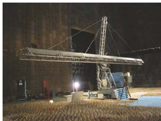
Измерения в БЭК в зоне Френеля спутниковой раскладной антенны X-диапазона РЛС «Северянин» размером 14 м (дальняя зона – 15 км!)
