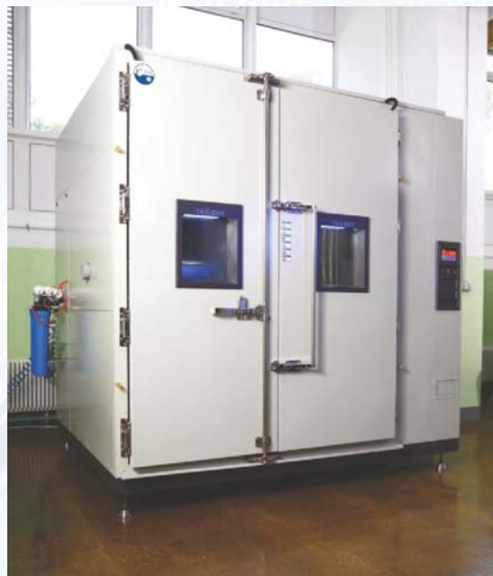
Климатическая камера для испытаний объектов на воздействие повышенной/пониженной температуры и влажность
